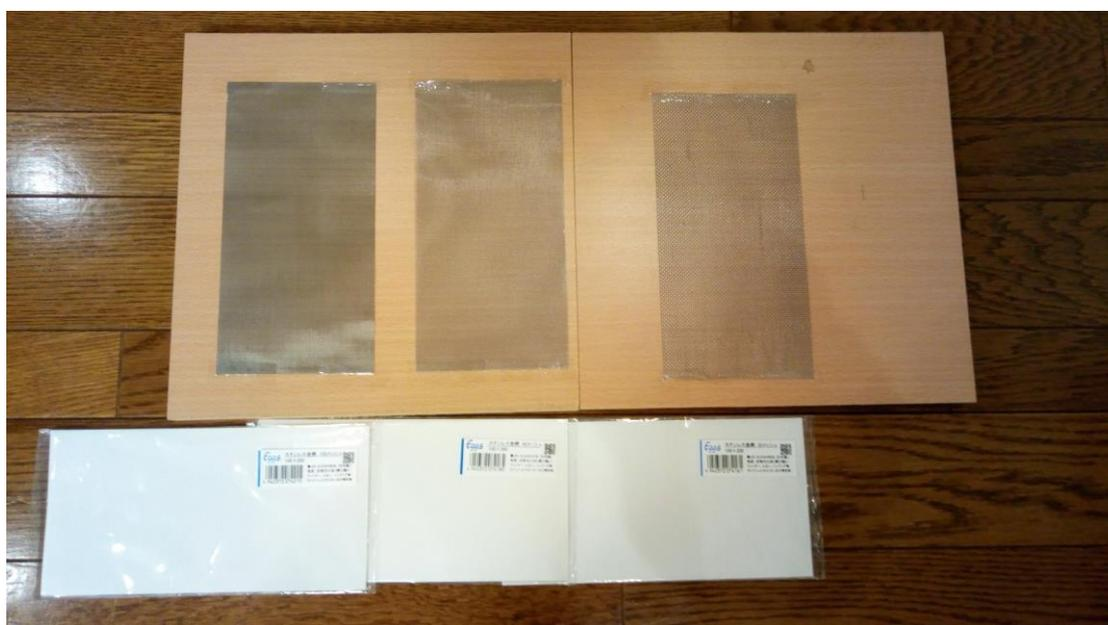
写真5 実験3に用いたステンレス製金網
