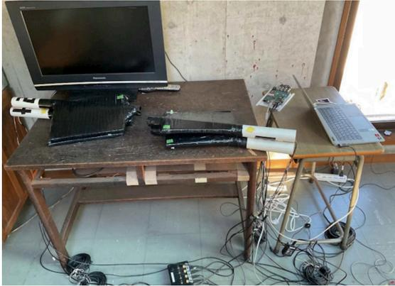
図2 学校に設置しているQuarknet検出器
