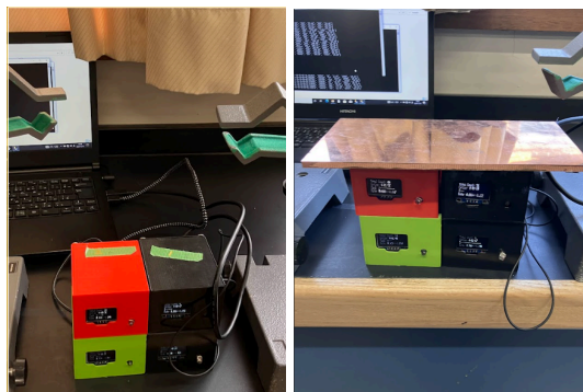
←図3 銅板なしの測定系。4台の検出器はコインシデンス されている。この測定系で、2024年11月26日から12月8 日、2月9日から2月14日に観測を行った。
